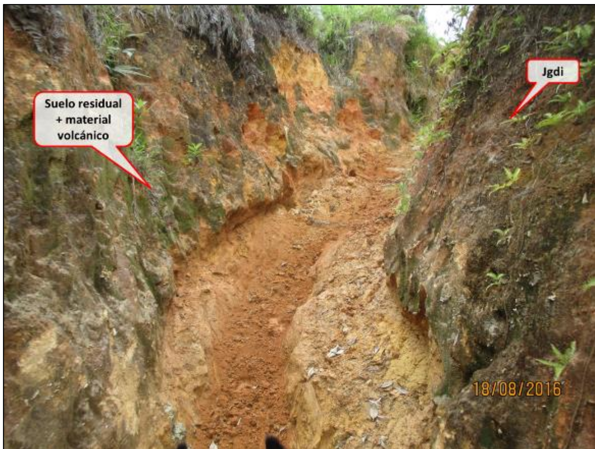
Figura 29. Suelo Residual del Batolito de Ibagué (Jgdi) Alterado por Materiales Volcánicos en su Mayoría de Tipo Ceniza. Coordenadas E= 858166.847995 N= 964373.714651 Altura: 2166.33 msnm.
