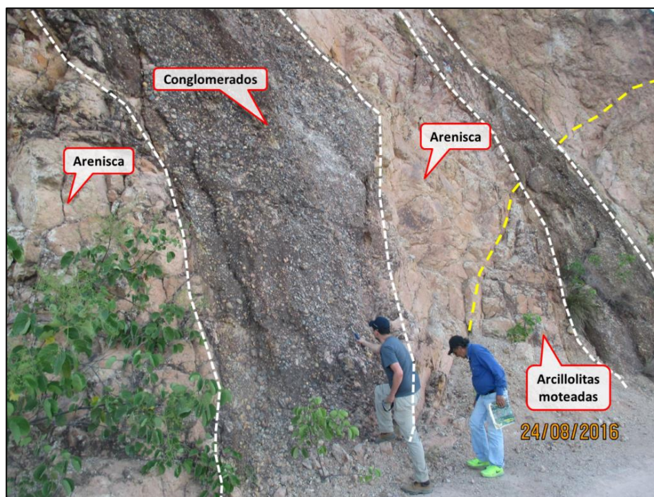
Figura 44. Intercalaciones de Conglomerados, Areniscas y Arcillolitas moteadas de la Formación Gualanday Superior (Pggs). Coordenadas: E= 888767.379825 N= 949943.528406 Altura: 530.83 msnm
