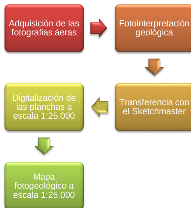
Figura 3. Diagrama de flujo de la metodología empleada en la fotointerpretación Fuente: GEOCING S.A.S, 2018
