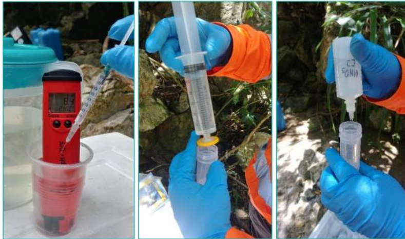
Fotografía 78. Estación QCAGAB, ubicada en la quebrada Chicalá aguas abajo, al suroeste del Pit Calizas. Arriba: Fotografía tomada desde QCAGAB con vista a aguas arriba. Abajo: De izquierda a derecha se observa el cálculo de alcalinidad con HCl 0,1M. Filtración de muestra para análisis de metales disueltos. Preservación de muestra con HNO 3 7M, para análisis de metales totales y disueltos. Fuente: WES Perú SAC, 2020.
