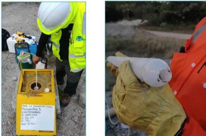
Fotografía 72. Piezómetro 1 (PZM1) tipo tubo abierto.
