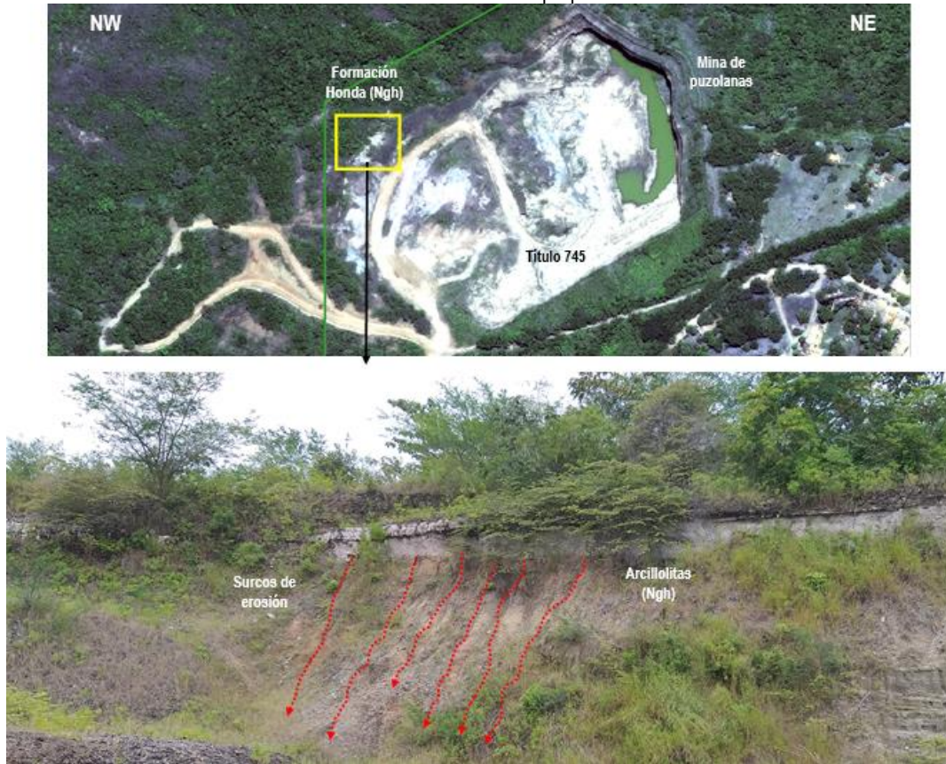
Fotografía 34. Análisis de la ortofoto de 2018 a escala 1:1200, y reconocimiento en campo (PM7), donde se observa erosión por escorrentía superficial en épocas de lluvias generando surcos de longitudes cortas hasta 5 m sobre superficies desprovistas de vegetación en rocas arcillolíticas de la formación Honda (Ngh) al oeste del área del título minero 745 de la mina La Esmeralda. Coord. Este 4 766 293; Coord. Norte 2 033 621
