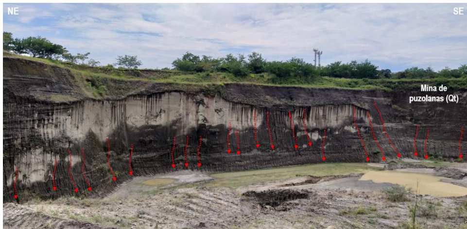
Fotografía 29. Generación de surcos de erosión afectando las paredes verticalizadas de la mina de puzolanas, depósitos cuaternarios (Qt), PM2, título minero 745 mina La Esmeralda. Coord. Este 4 766 550; Coord. Norte 2 033 731.
