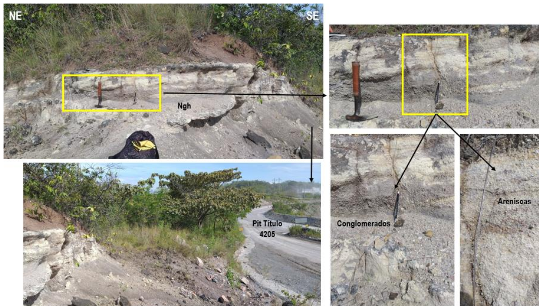
Fotografía 5. Areniscas de grano medio a conglomerático y capas delgadas de conglomerados en matriz areno-arcillosa con gravas tamaños gránulos de rocas de variada composición de formas subredondeadas a subangulares en el punto de control 833 al sur del polígono 745 y título de explotación actual 4205 mina La Esmeralda. Coord. Este 4 766 263; Coord. Norte 2 033 548.
