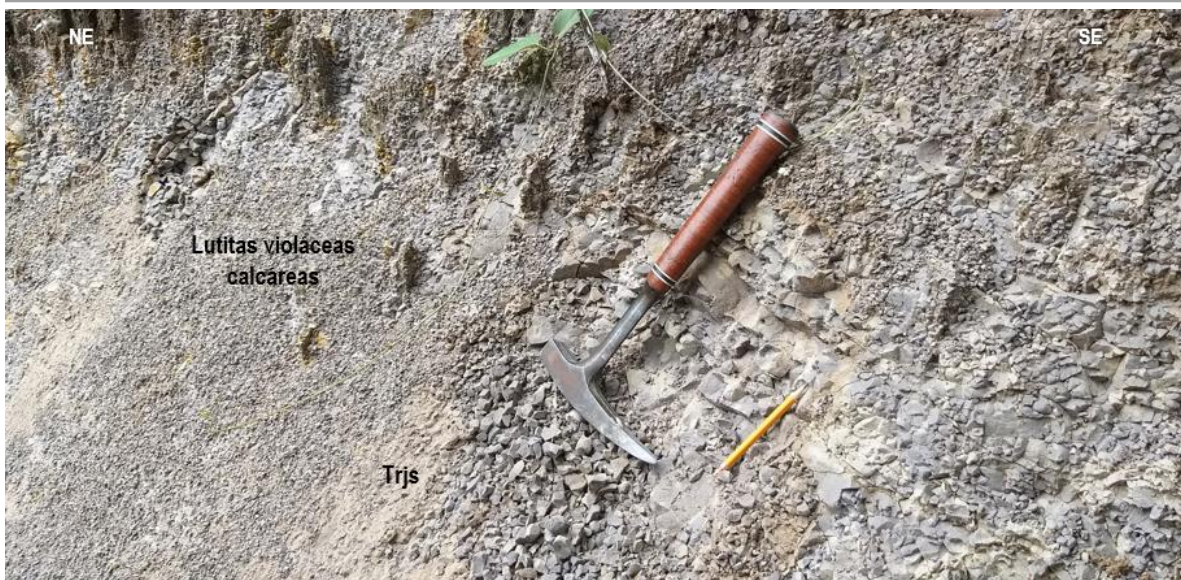
Fotografía 8. Lutitas de tonos violáceos calcáreas con líticos oscuros volcánicos de la Formación Saldaña (Trjs), meteorizadas y muy fracturadas, adyacente al área del título minero 745 punto de control 852. Coord. Este 4 766 343; Coord. Norte 2 033 866. Fuente: Elaboración propia.
