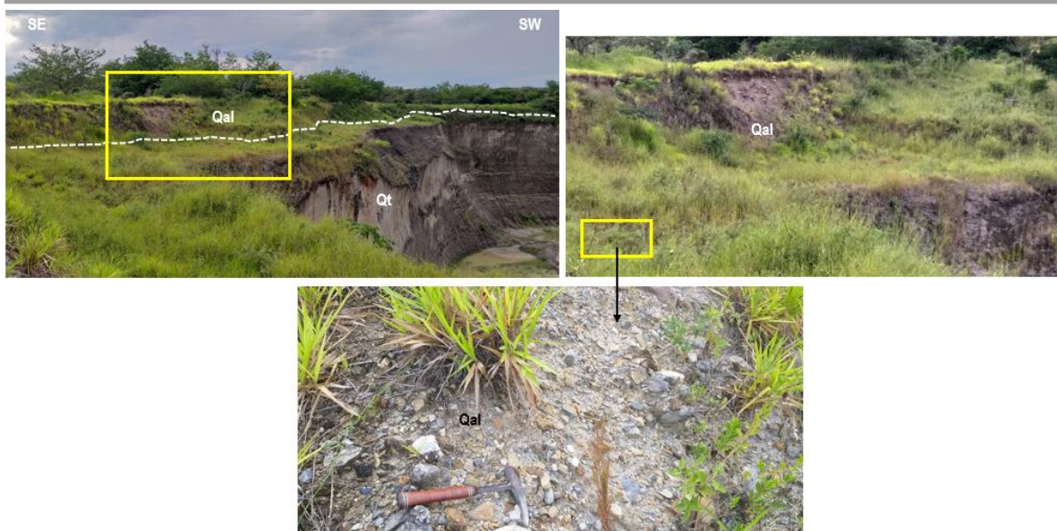
Fotografía 1. Depósitos aluviales (Qal) cubriendo de manera discordante los depósitos de arenas puzolánicas, sobre el punto de control 834, mina de puzolanas. Coord. Este 4 766 552; Coord. Norte 2 033 731. Fuente: Elaboración propia.
