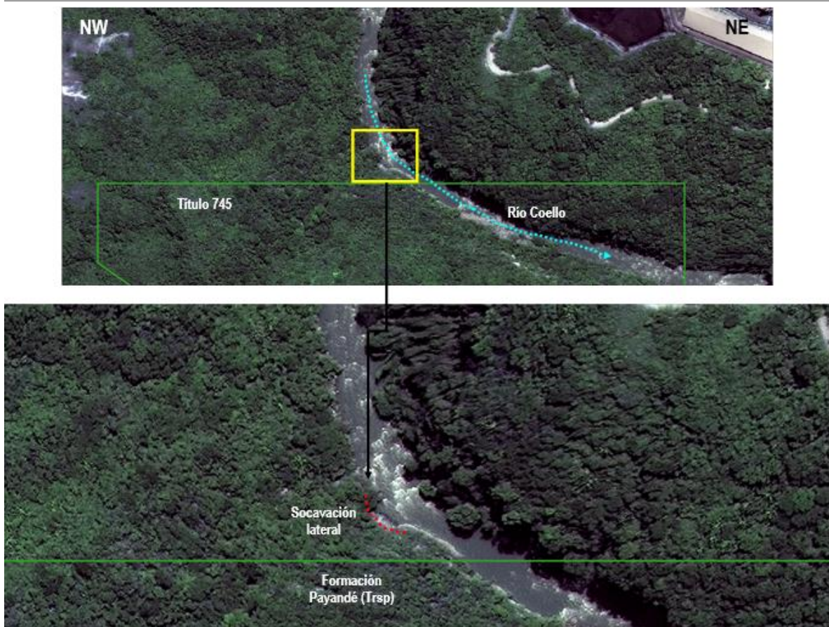
Fotografía 36. Análisis de la ortofoto de 2018 a escala 1:1200, (PM9); se presenta erosión fluvial por socavación lateral margen derecha del río Coello, en morfologías inclinadas asociadas a las rocas calcáreas de la Formación Payandé (Trsp). Coord. Este 4 766 606; Coord. Norte 2 034 115.
