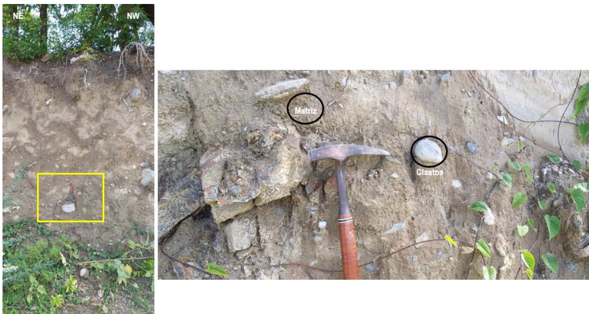
Fotografía 2. Depósitos aluviales (Qal), sobre el punto de control 832, matriz soportados, con un espesor de 4 m, adyacente mina de puzolanas. Coord. Este 4 766 418; Coord. Norte 2 033 454. Fuente: Elaboración propia.
