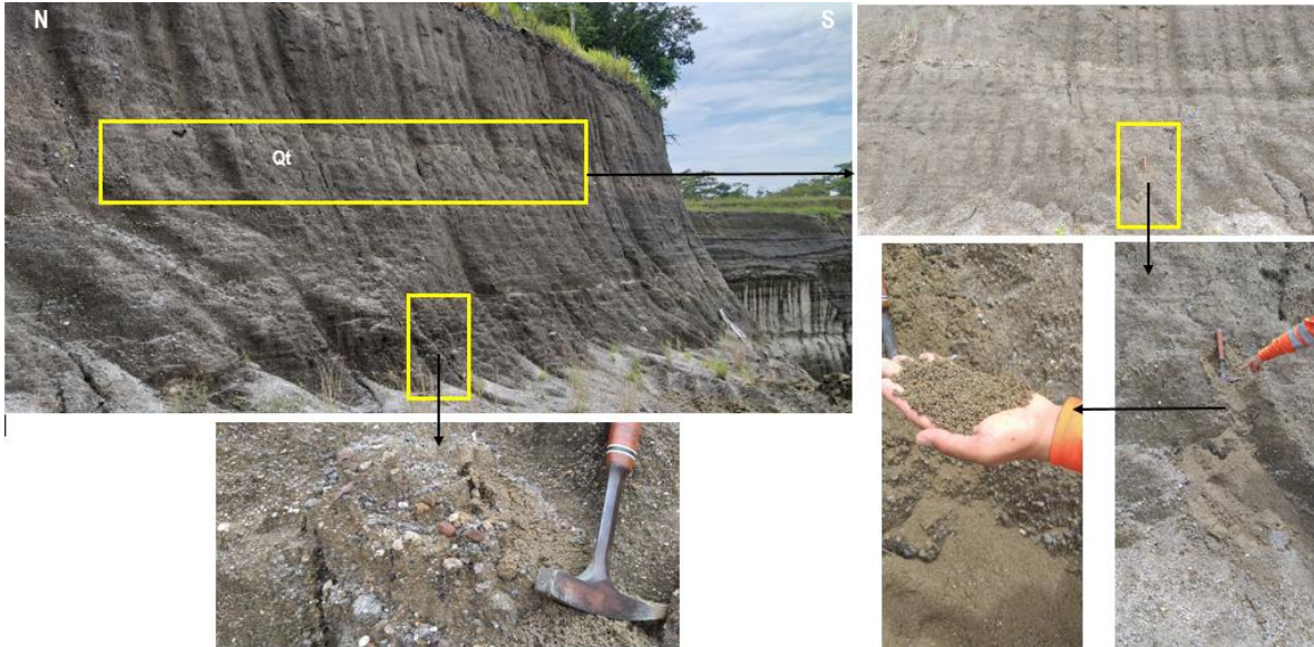
Fotografía 3. Depósitos aluviales de morfología de terrazas (Qt) asociado a arenas medias a gruesas con gravas de rocas volcánicas, intrusivas y sedimentarias principalmente, de formas subredondeadas, conformando la mina de puzolanas, punto de control 826. Coord. Este 4 766 411; Coord. Norte 2 033 729.
