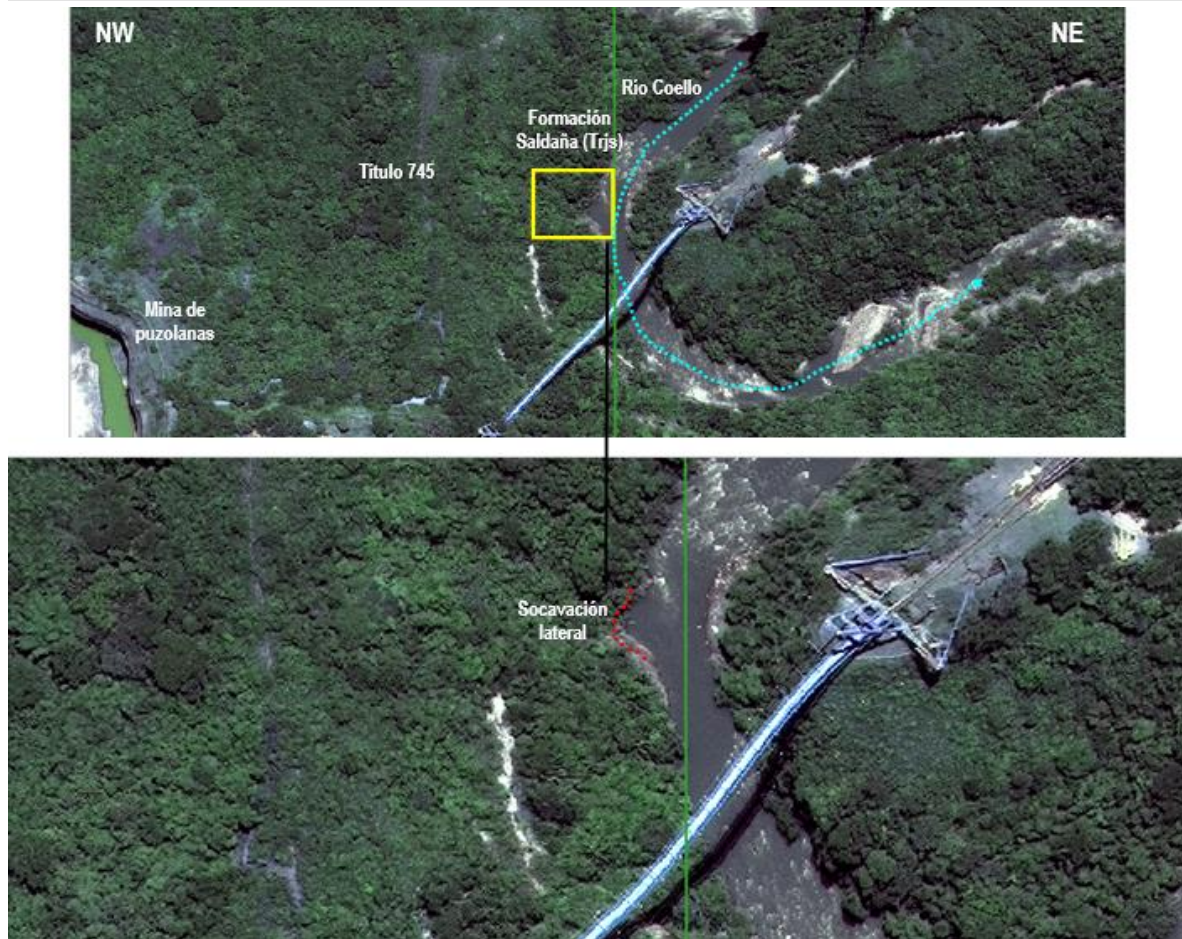
Fotografía 37. Análisis de la ortofoto de 2018 a escala 1:1200, (PM10), se presenta erosión fluvial por socavación lateral margen derecha del río Coello, afectando morfologías inclinadas en rocas lutíticas y calcáreas de la Formación Saldaña (Trjs), al este del área del título minero 745 de la mina La Esmeralda. Coord. Este 4 766 957; Coord. Norte 2 033 797. Fuente: Elaboración propia.
