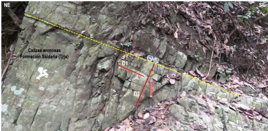
Fotografía 20. Calizas arenosas de grano fino grisáceas con esporádicas venillas de carbonatos, líticas oscuras, cortadas por diques afaníticos de composición andesítica, de la Formación Saldaña (Trjs),; se muestra la estratificación con buzamiento al SE y dos familias de diaclasas, una ortogonal a la estratificación, punto de control 854. Coord. Este 4 766 351; Coord. Norte 2 033 974 Fuente: Elaboración propia.
