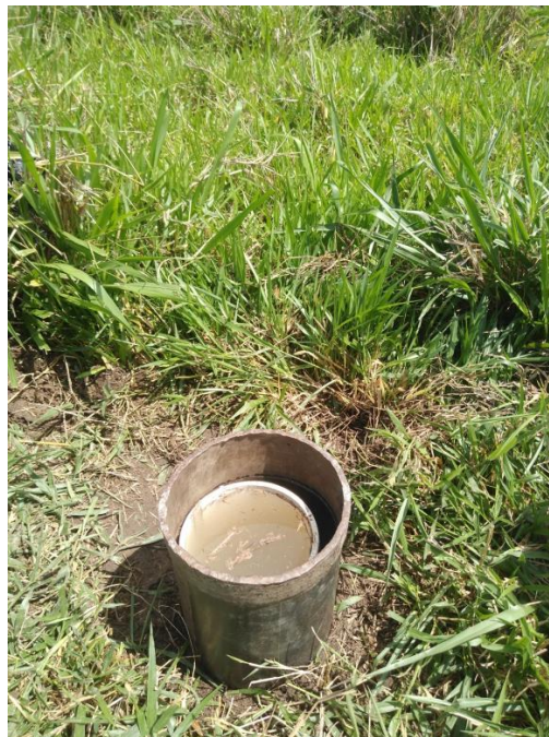
Fotografía 4. Infiltrómetro de Doble Anillo Fuente: INGETEC, 2021.
