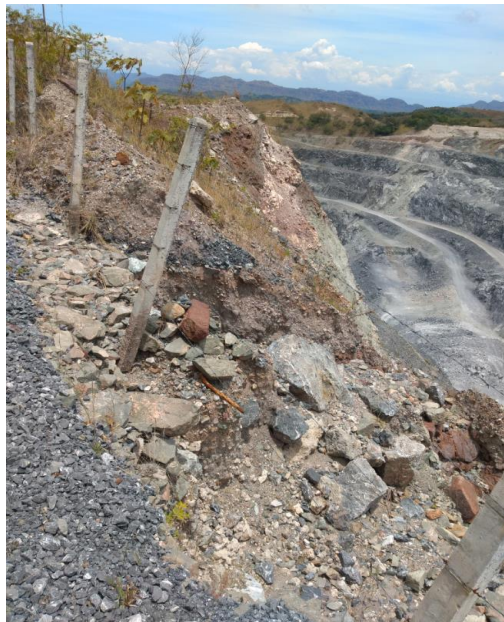
Fotografía 3. Proceso erosivo parte alta de zona de extracción Caliza Fuente: Elaboración Propia
