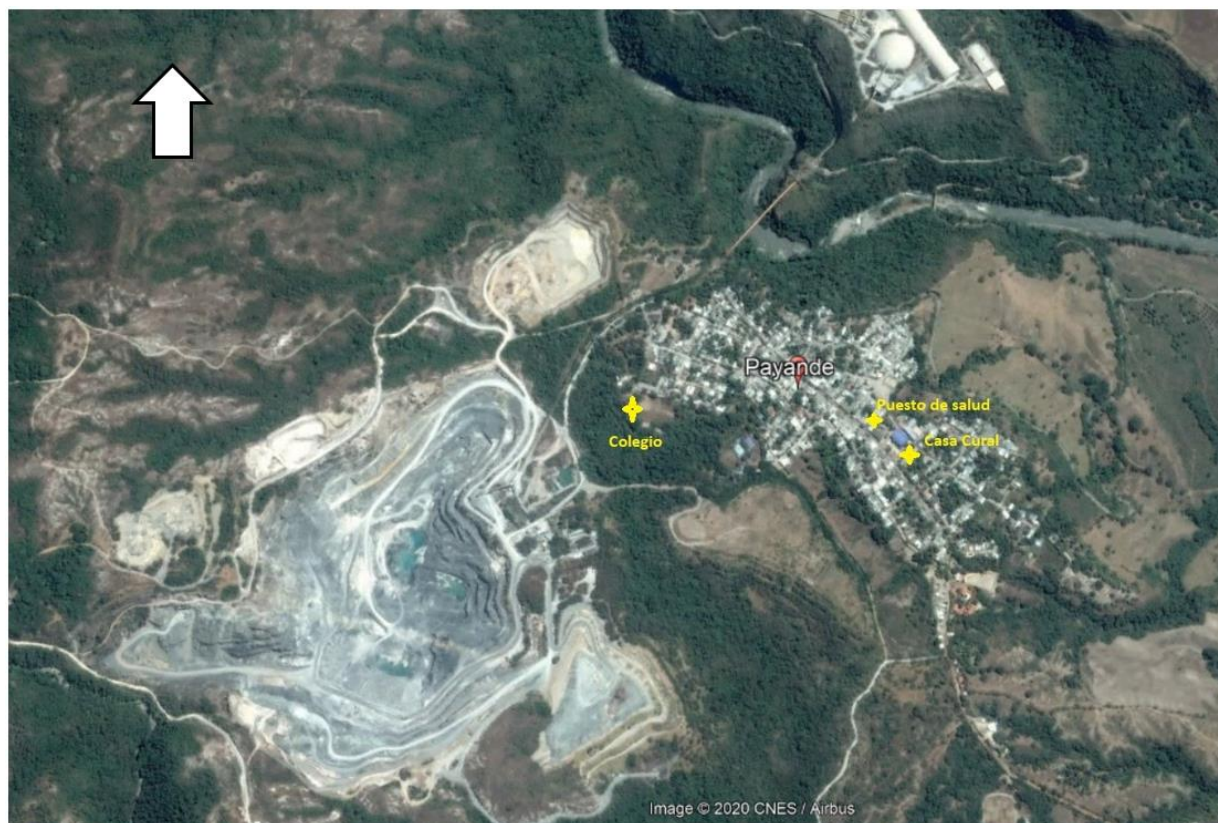
Figura 36. Ubicación de los tres puntos de monitoreo de vibraciones disponibles en la zona de influencia del proyecto Fuente: Elaboración propia
