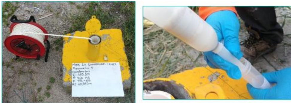
Fotografía 101. Monitoreo y muestreo de Piezómetro 5 (PZM5) tipo tubo abierto. Izquierda: Medición de la profundidad del agua en PZM3. Derecha: Extracción de muestra en el PZM3. Fuente: WES Perú SAC, 2020
