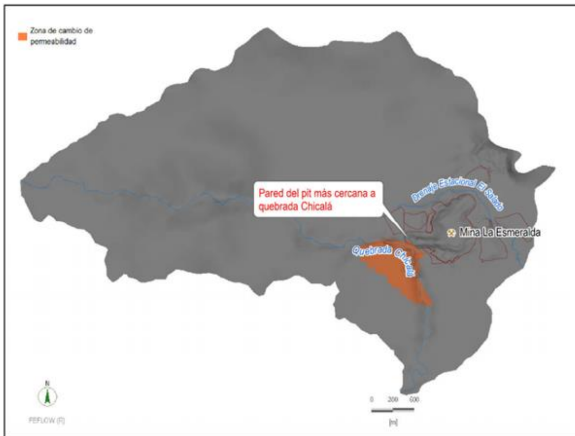
Figura 160. Zona donde se Aplicó el Cambio de Permeabilidad dentro del Modelo Numérico. Fuente: WES Perú SAC, 2019.
