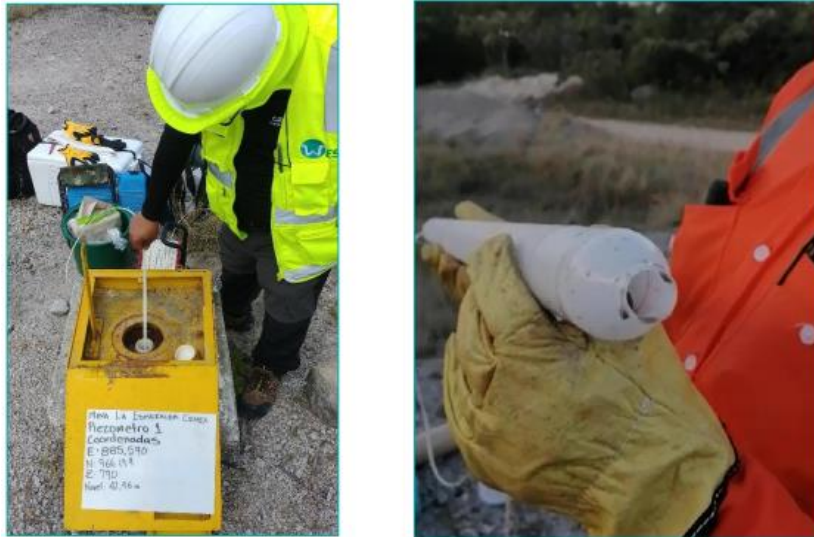
Fotografía 99. Piezómetro 1 (PZM1) tipo tubo abierto. Izquierda: Medición del nivel de agua mediante el Water Level Meters. Derecha: Muestreador (bailer 1") luego de introducirlo a PZM1, donde se observa extracción de sedimentos. Fuente: WES Perú SAC, 2020
