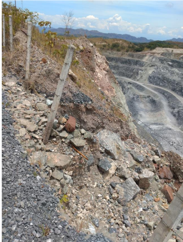
Fotografía 120. Proceso erosivo parte alta de zona de extracción Caliza Título minero 4205 Fuente: Elaboración propia
