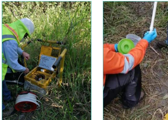
Fotografía 100. Monitoreo y muestreo de Piezómetro 3 (PZM3) tipo tubo abierto. Izquierda: Medición de la profundidad del agua en PZM3. Derecha: Extracción de muestra en el PZM3. Fuente: WES Perú SAC, 2020
