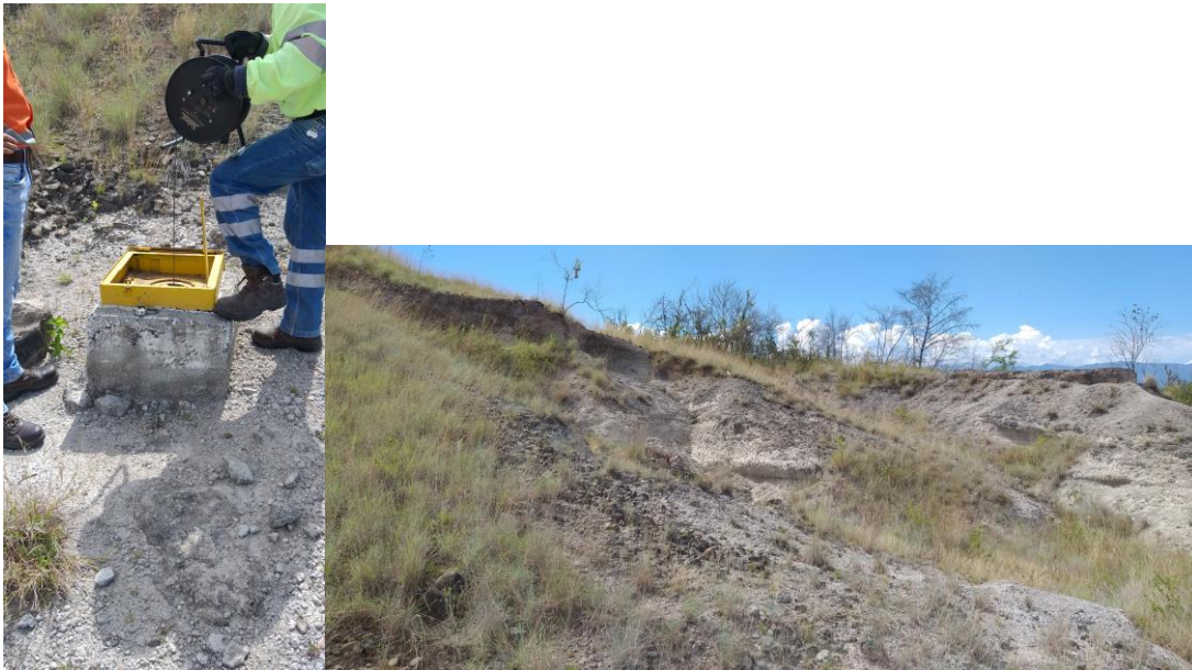
Fotografía 97. a.) Medición del piezómetro PZ-01. , b.) Rocas de la formación Honda en el piezómetro PZ-01, sector pit sur mina La Esmeralda.
