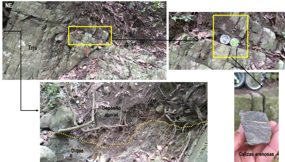
Fotografía 17. Calizas arenosas de grano fino grisáceas con esporádicas venillas de carbonatos, líticos oscuros, cortadas por diques afaníticos de composición andesítica de tonos gris verdoso oscuro, de la Formación Saldaña (Trjs), título minero 6823, punto de control 854. Coord. Este 4 766 351; Coord. Norte 2 033 974.
