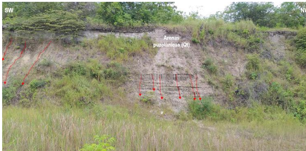
Fotografía 46. Generación de surcos de erosión afectando suelos de los depósitos cuaternarios (Qt) de arenas puzolánicas, PM1, título minero 6823, mina La Esmeralda. Coord. Este 4 766 409; Coord. Norte 2 033 729.
