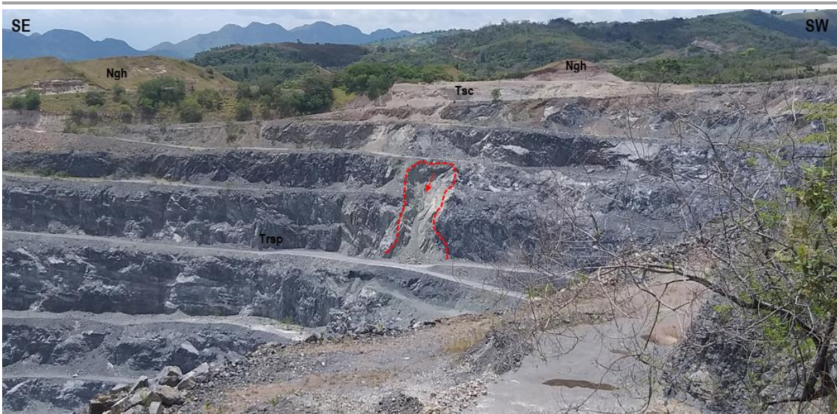
Fotografía 60. Proceso asociado a deslizamiento local, de detritos y rocas en talud sur del pit minero 4205, calizas de la formación Payandé (Trsp), adyacente al título minero 6823, sin afectación directa sobre este título; identificado en 2018 como caídas de bloques PRM2. Coord. Este 4 766 482; Coord. Norte 2 033 242.
