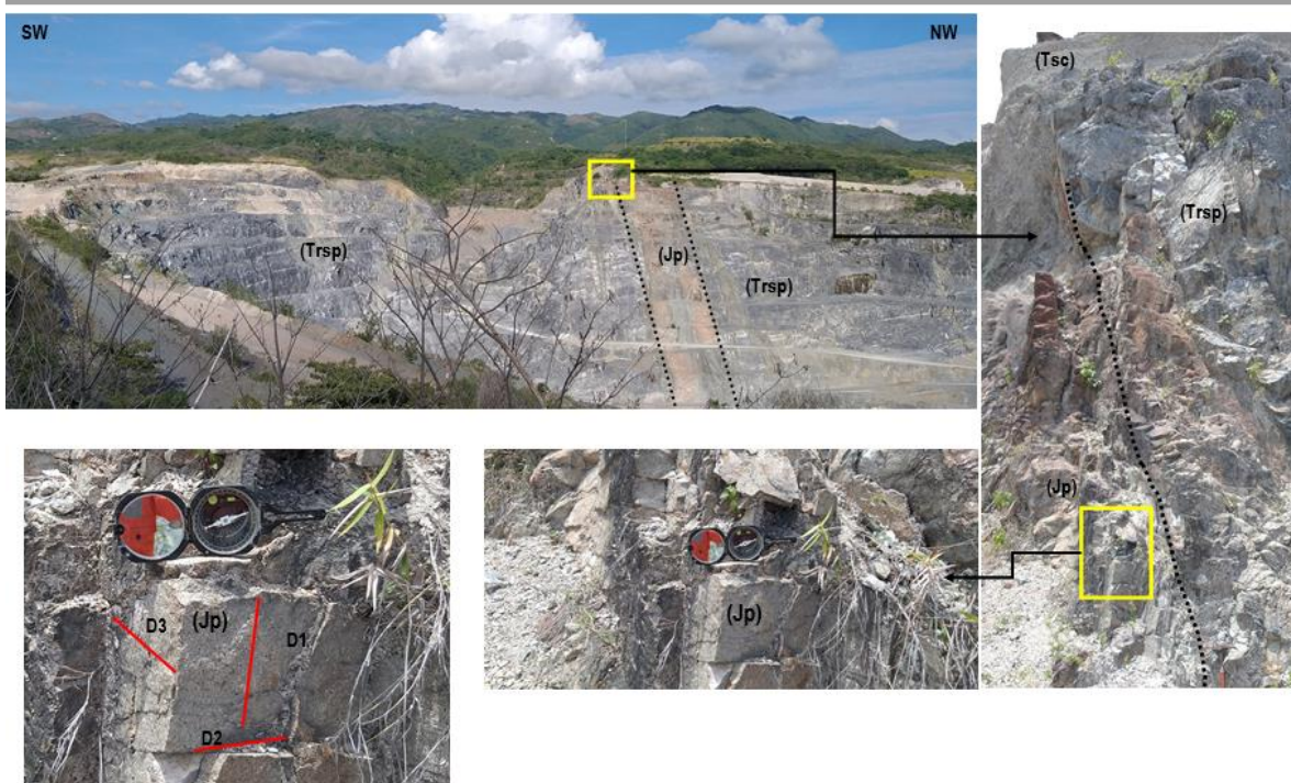
Fotografía 38. Rocas subvolcánicas de textura porfírica, color pardo rosado opaco del dique Stock de Payandé (Jp), intruye calizas de la formación Payandé (Trjs), mostrando tres familias de diaclasamiento, punto de control 815 al sur del polígono título minero 6823 de la mina La Esmeralda. Coord. Este 4 765 662; Coord. Norte 2 032 812 Fuente: Elaboración Propia.
