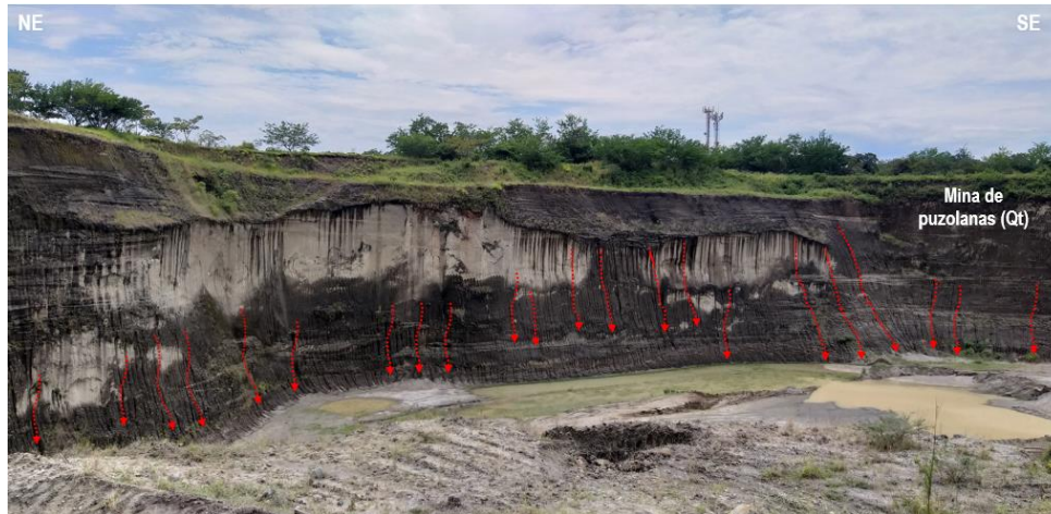
Fotografía 47. Generación de surcos de erosión afectando las paredes verticalizadas de la mina de puzolanas, depósitos cuaternarios (Qt), PM2, título minero 6823, mina La Esmeralda. Coord. Este 4 766 550; Coord. Norte 2 033 731.
