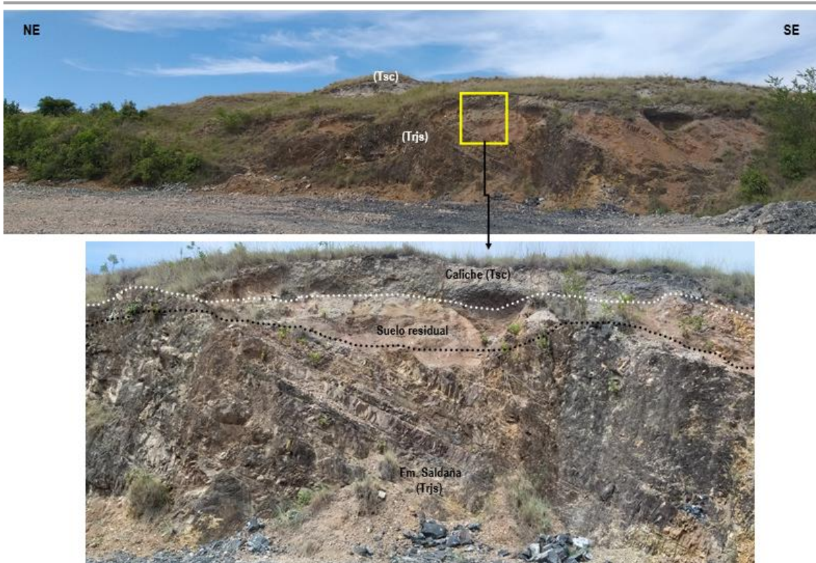
Fotografía 22. Desarrollo de suelo residual arcillo-arenoso de color amarillento, cubierto por los depósitos de Caliche (Tsc), seguido del suelo se presentan areniscas tobáceas y tobas con carbonatos de la Formación Saldaña (Trjs), con perfil IIA de rocas meteorizadas (Deere & Patton, 1971), punto de control 822, título minero 6823. Coord. Este 4 765 269; Coord. Norte 2 032 991.
