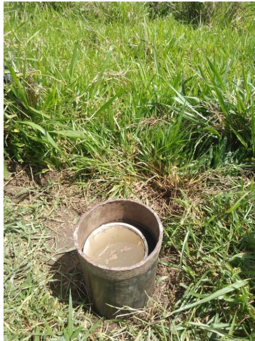
Fotografía 4. Infiltrómetro de Doble Anillo Fuente: INGETEC, 2021.
