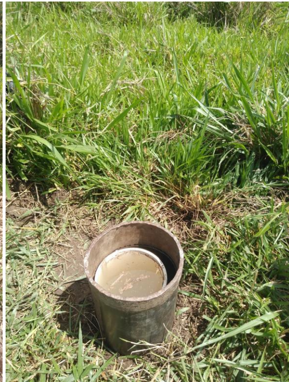
Fotografía 2. Prueba de infiltración en campo
