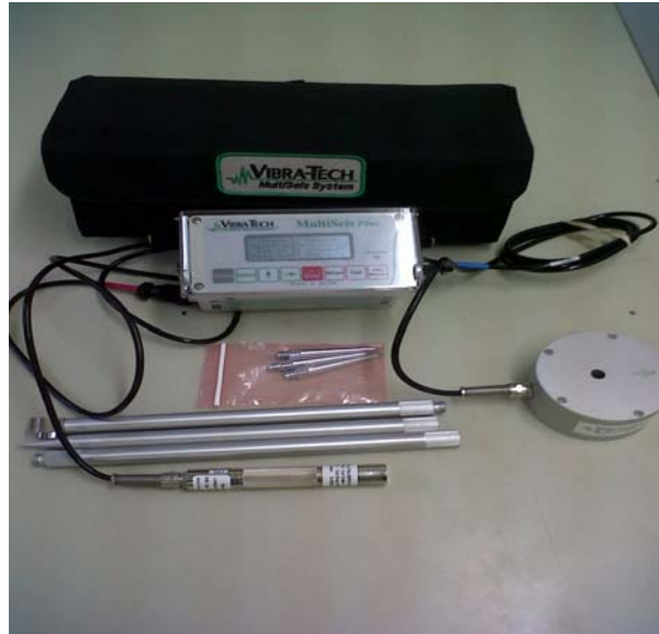
Foto 6.6. Sismógrafo Digital Multiseis Plus de Vibrattech, equipo utilizado por Cemex actualmente.
