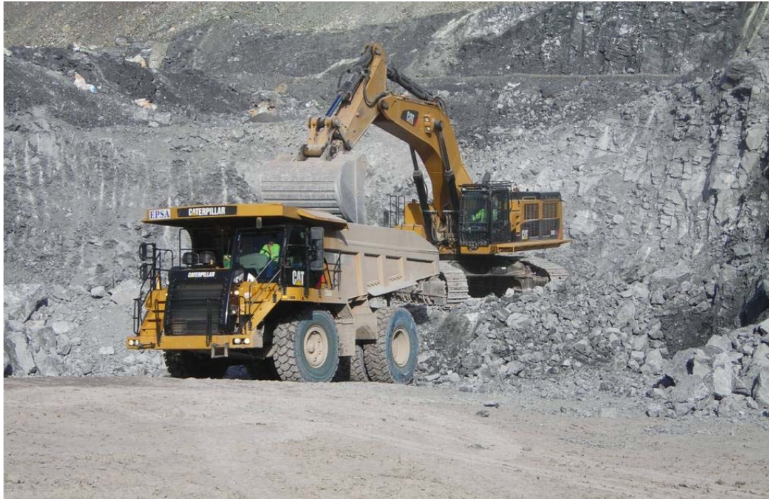
Foto 6.10. Operación de cargue material
