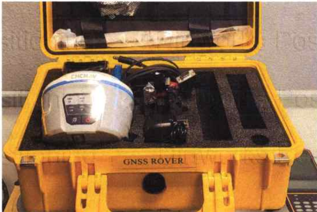
Figura 10. Equipo utilizado – CHC i50 – Consultor.
