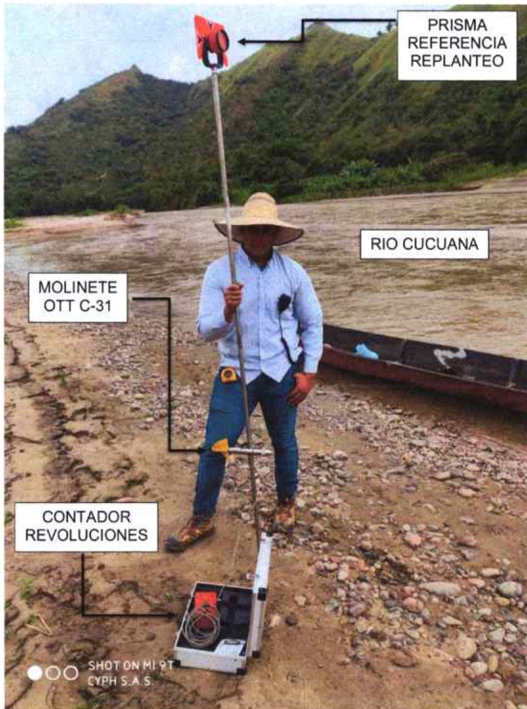
Figura 50. Trabajos de campo de batimetría aguas arriba- CYPH S.A.S.
